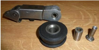
Das Originalteil muss vorsichtig angebohrt werden, um es aus dem Spanner zu entfernen. Der von Honda installierte Aluminiumverschlussstopfen muss rückstandsfrei ausgebohrt werden. Hierbei ist auf die genaue Bohrtiefe zu achten.
