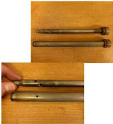
Dämpferrohre F1 oben, K2/K6 unten
