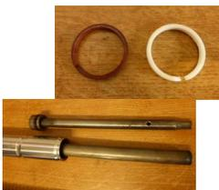
Kolbenring alt und neu    Unterschied F1 zu K2/K6 Dämpferrohr
