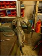
Fressspuren im unteren Bereich des Standrohres
